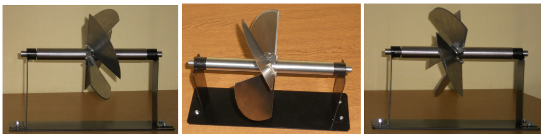
Рисунок 2 – Общий вид макетного образца Р.О.Д. с эллиптическими лопастями
