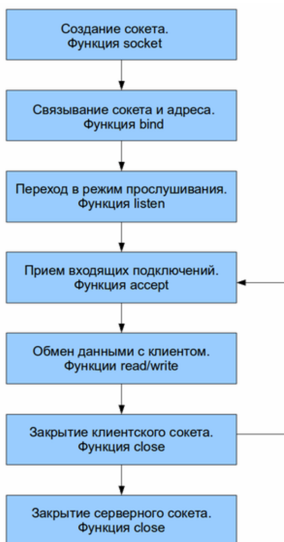
Рисунок 1 - Структура типичного серверного приложения основанного на сокетах Беркли
