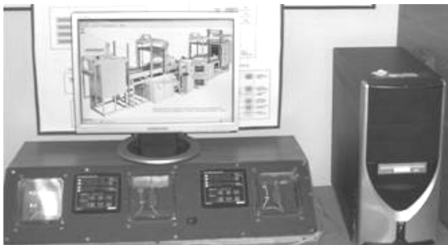
Рисунок 2 - Стенд для моделирования системы автоматического управления параметрами процесса закалки инструментальных сталей
